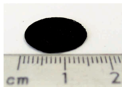
■ Buckypaper připravený z disperze SWCNT
