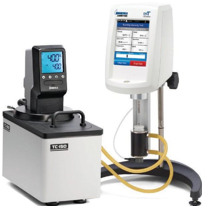
Kompletní systém viskozimetru DV2T a adaptéru pro malé vzorky SSA s cirkulačním termostatem pro temperaturu vzorku.
