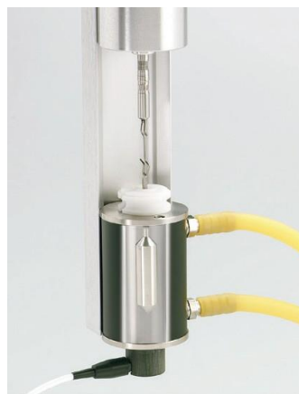
Standardní komora pro vzorek s teplotním čidlem pro přímé měření teploty vzorku
