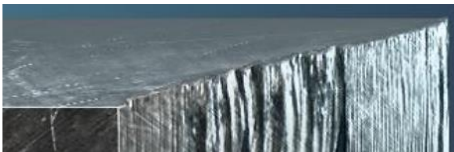
Obr. 3: Ukázka struktury nepravidelného profilu s okujemi
