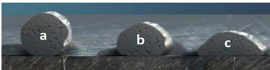
Obr. 4: Kuličky po svařování, pro P3 nepřijatelné (a+b+c)
