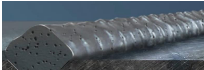
Obr. 5: Ostrohranný a nepravidelný svar
