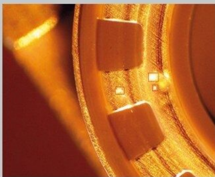
Obr. 1 Fotografie kontaminantu na elektronické součástce (červený rámeček). Infračervenou spektroskopií identifikován polystyren
