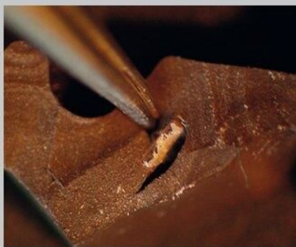
Obr. 2 Fotografie kontaminantu na gumovém těsnění (červený rámeček). Infračervenou spektroskopií identifikován plněný polypropylen (bílá hmota)
